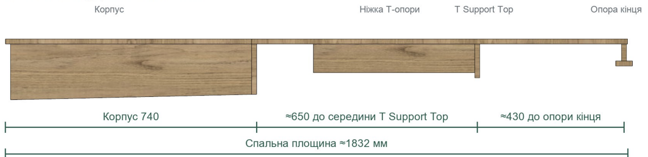
Положення опор у розкладеному стані (вигляд збоку, розміри орієнтовні)
